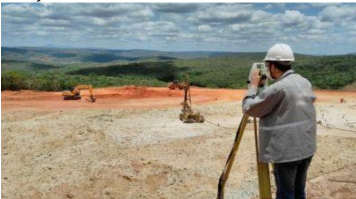
Estação Total é um equipamento que possui características eletrônicas e mecânicas que são capazes de coletar e armazenar dados de medidas de ângulos e distâncias que
