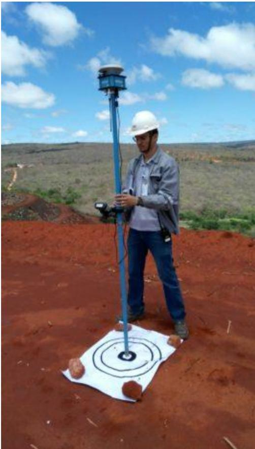
Um Sistema GNSS RTK, conhecido também como GPS RTK, é um conjunto de equipamentos eletrônicos capazes de coletar dados geoespaciais transmitidos por satélites a fim de obter coordenadas precisas, tanto em modo estático (pós-processado) como em modo RTK (Real Time Kinematic). São compostos por 02 (dois) receptores GNSS (base + rover), rádio de comunicação, coletor de dados, cabos de comunicação e acessórios de fixação.
